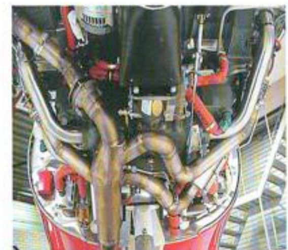
De onderzijde van de motor. Maatwerk leidt tot minder weerstand.
