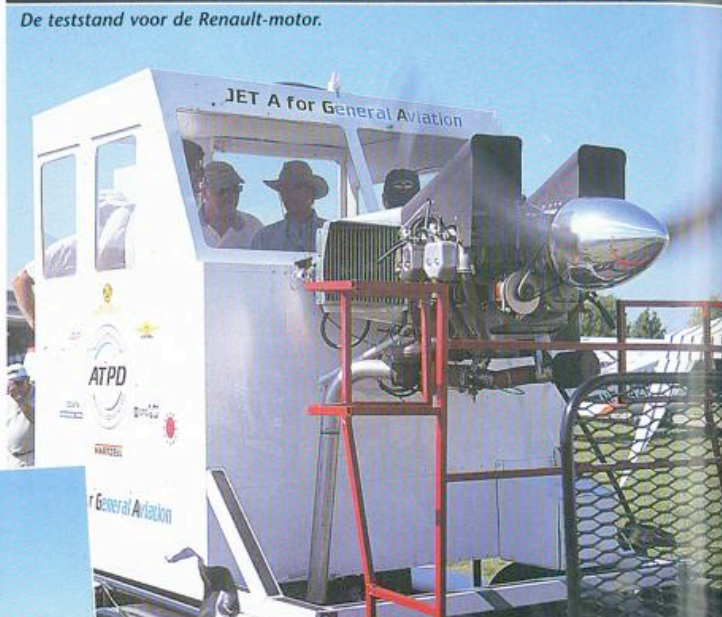
De teststand voor de Renault-motor.
