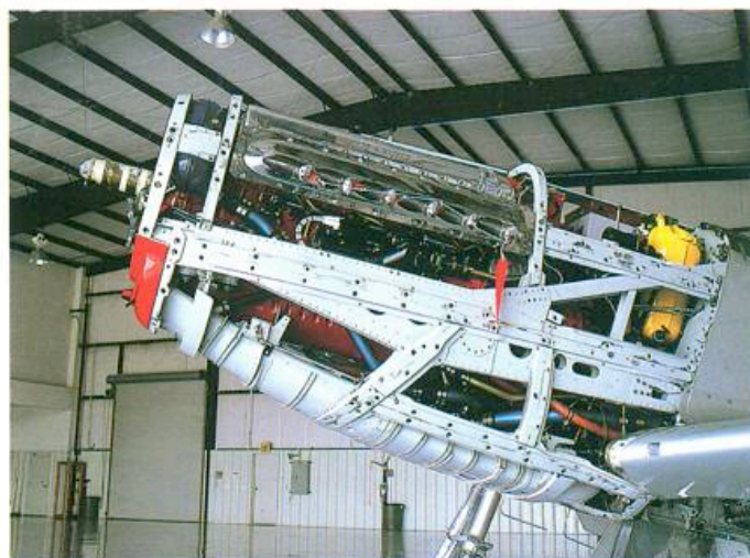
De twaalfcilinder Merlin van een van de zusterschepen van Crazy Horse.
