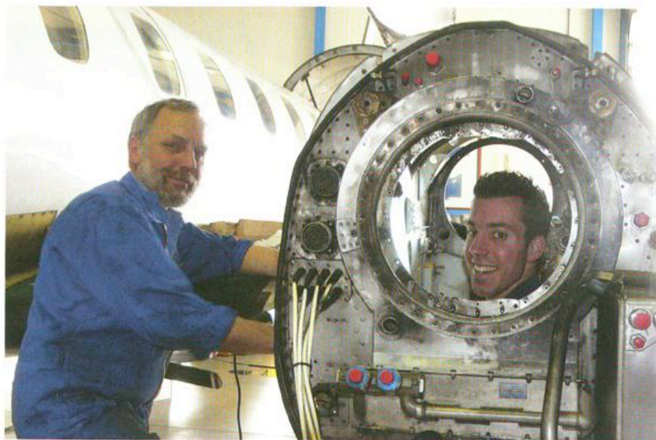
Vader en zoon Van de Bos druk bezig met plaatwerkreparatie aan een motorinlaat. (Foto: Goof Bakker)
