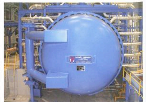
De kunststofdelen van de 787 worden in gigantische autoclaven 'gebakken'.
